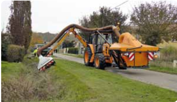
Système de fauche avec aspiration utilisé par la communauté de communes de l'Isle Crémieu, 28 000 hab.
